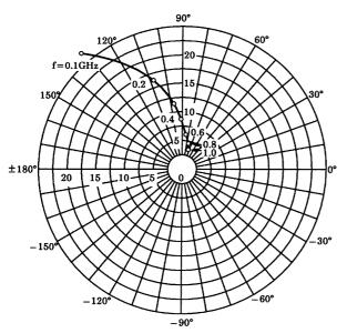
S22e  $V_{CE} = 10V$   $I_{C} = 20mA$   $T_{a} = 25^{\circ}C$  (UNIT :  $\Omega$ )  $_{j50}$   $_{j100}$   $_{j150}$   $_{j150}$   $_{j150}$   $_{j100}$   $_{j150}$   $_{j150}$
