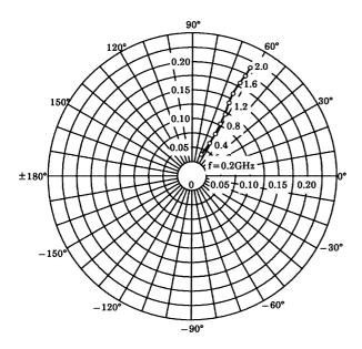
$S_{22e}$   $V_{CE} = 8V$   $I_{C} = 5mA$   $Ta = 25^{\circ}C$   $(UNIT : \Omega)$
