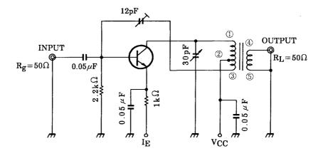
T: 1 - 2 0.1mm \$\phi\$ UEW 20T 2 - 3 0.1mm \$\phi\$ UEW 8T 4 - 5 0.1mm \$\phi\$ UEW 2T
