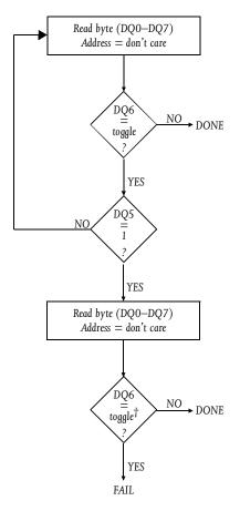
$<sup>^{\</sup>dagger}$ DQ6 rechecked even if DQ5 = 1 because DQ6 may stop toggling when DQ5 changes to 1.
