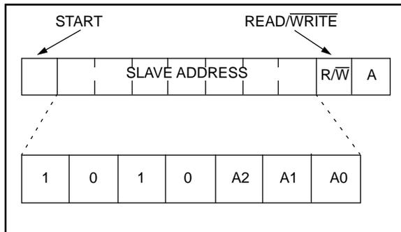
**FIGURE 4-1: BYTE WRITE**
