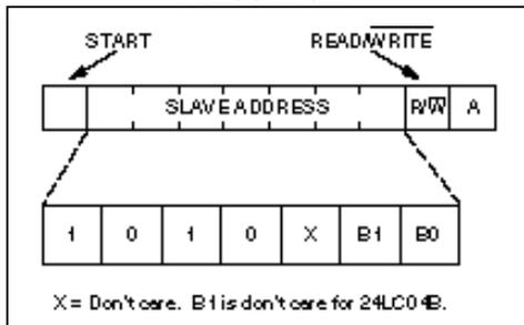
**FIGURE 5-1: BYTE WRITE**
