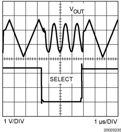
**FIGURE 6. 2:1 MUX Output**
