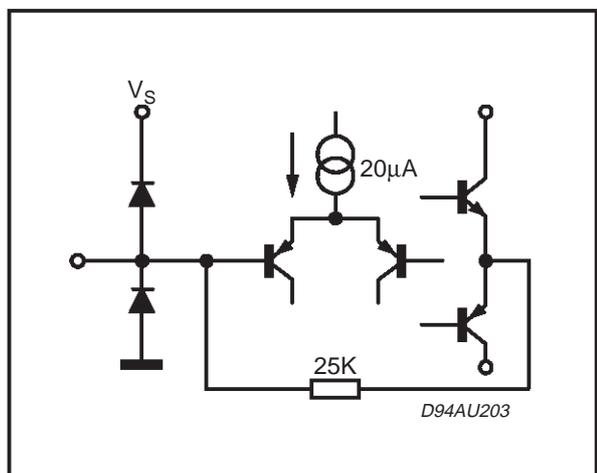
**PIN:** LOUT, ROUT, REC-OUT-1 REC-OUT-R
