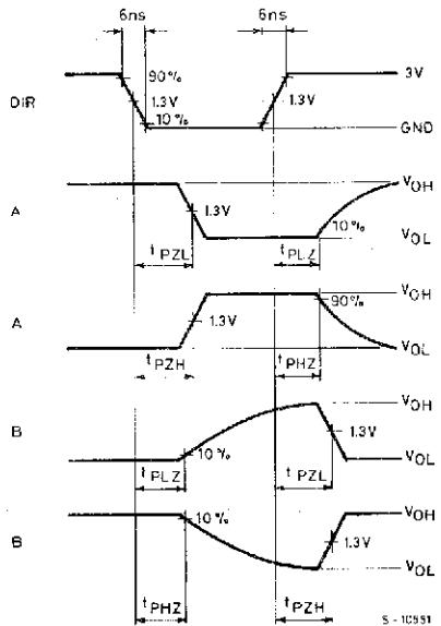
**TEST WAVEFORM I<sub>cc</sub> (Opr.)**
