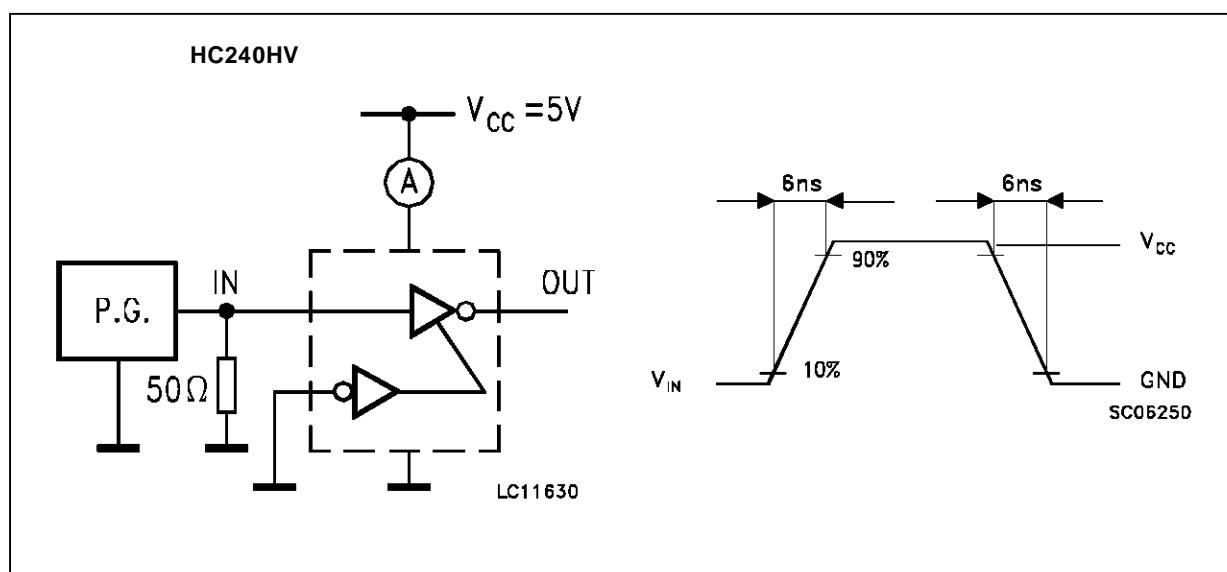
**SWITCHING CHARACTERISTICS TEST CIRCUIT**
