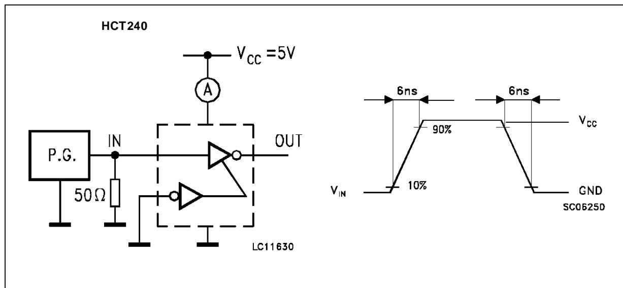
**SWITCHING CHARACTERISTICS TEST WAVEFORM**
