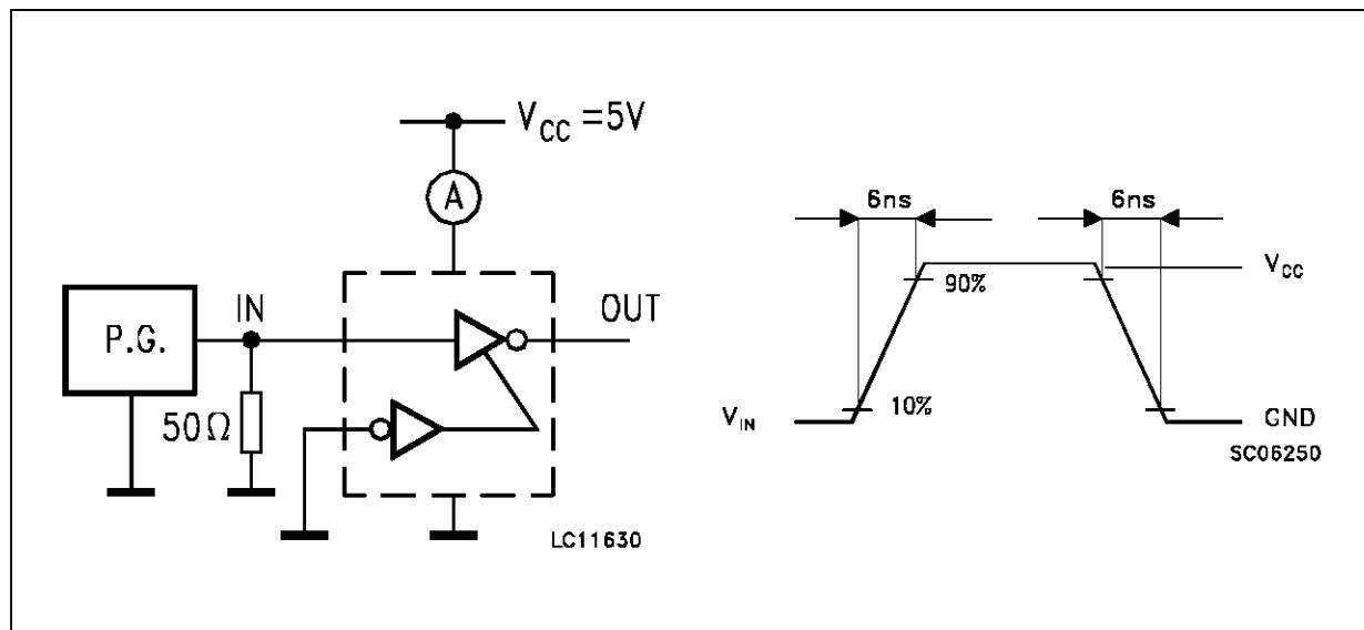
**SWITCHING CHARACTERISTICS TEST CIRCUIT**
