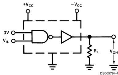
FIGURE 2.  $V_{IL}$ ,  $V_{OH}$
