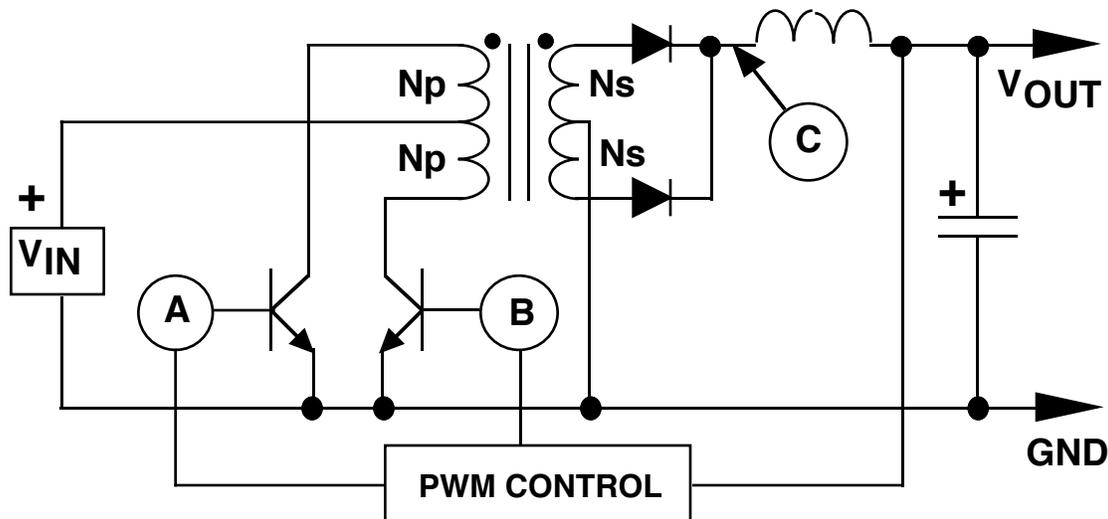
FIGURE 35. PUSH-PULL CONVERTER
