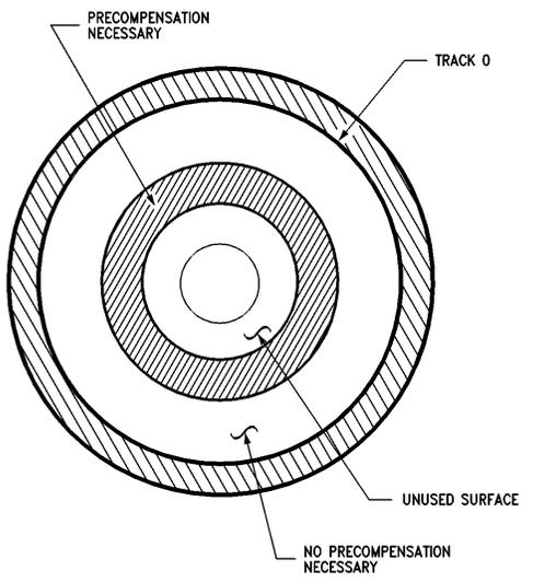
FIGURE 1.7. Bit Shifting
