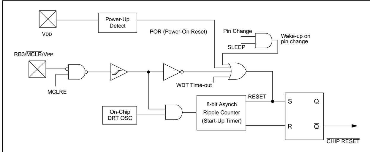
**FIGURE 7-9: TIME-OUT SEQUENCE ON POWER-UP ( $\overline{\text{MCLR}}$  PULLED LOW)**
