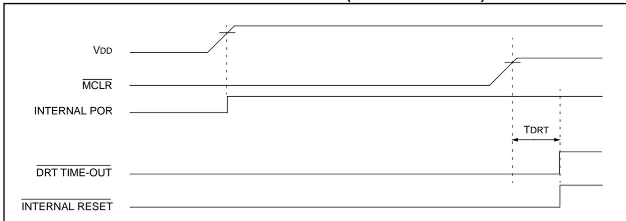
**FIGURE 7-10: TIME-OUT SEQUENCE ON POWER-UP ( $\overline{\text{MCLR}}$  TIED TO V<sub>DD</sub>): FAST V<sub>DD</sub> RISE TIME**
