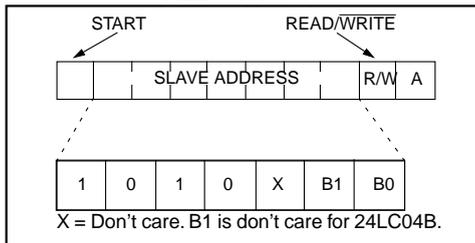
**FIGURE 4-1: BYTE WRITE**
