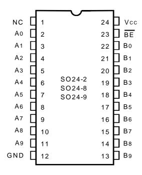
SOIC/ QSOP/ TSSOP TOP VIEW
