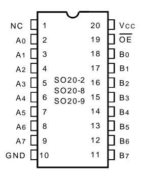
SOIC/ QSOP/ TSSOP TOP VIEW
