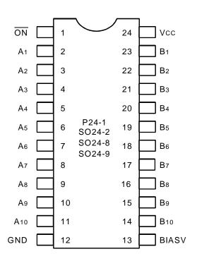
PDIP/ SOIC/ QSOP/ TSSOP TOP VIEW
