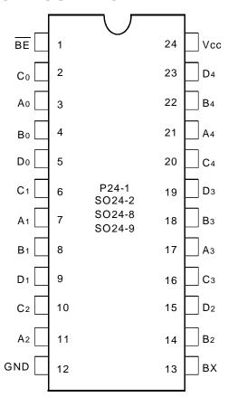
PDIP/ SOIC/ QSOP/ TSSOP TOP VIEW
