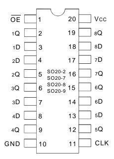
SOIC/ SSOP/ QSOP/ TSSOP TOP VIEW
