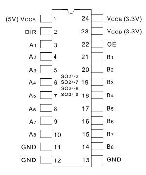
SOIC/ SSOP/ QSOP/ TSSOP TOP VIEW
