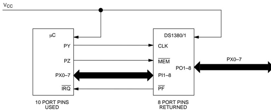
**MICROPROCESSOR INTERFACE USING DS1380 2K X 8 NV RAM ONLY Figure 5**
