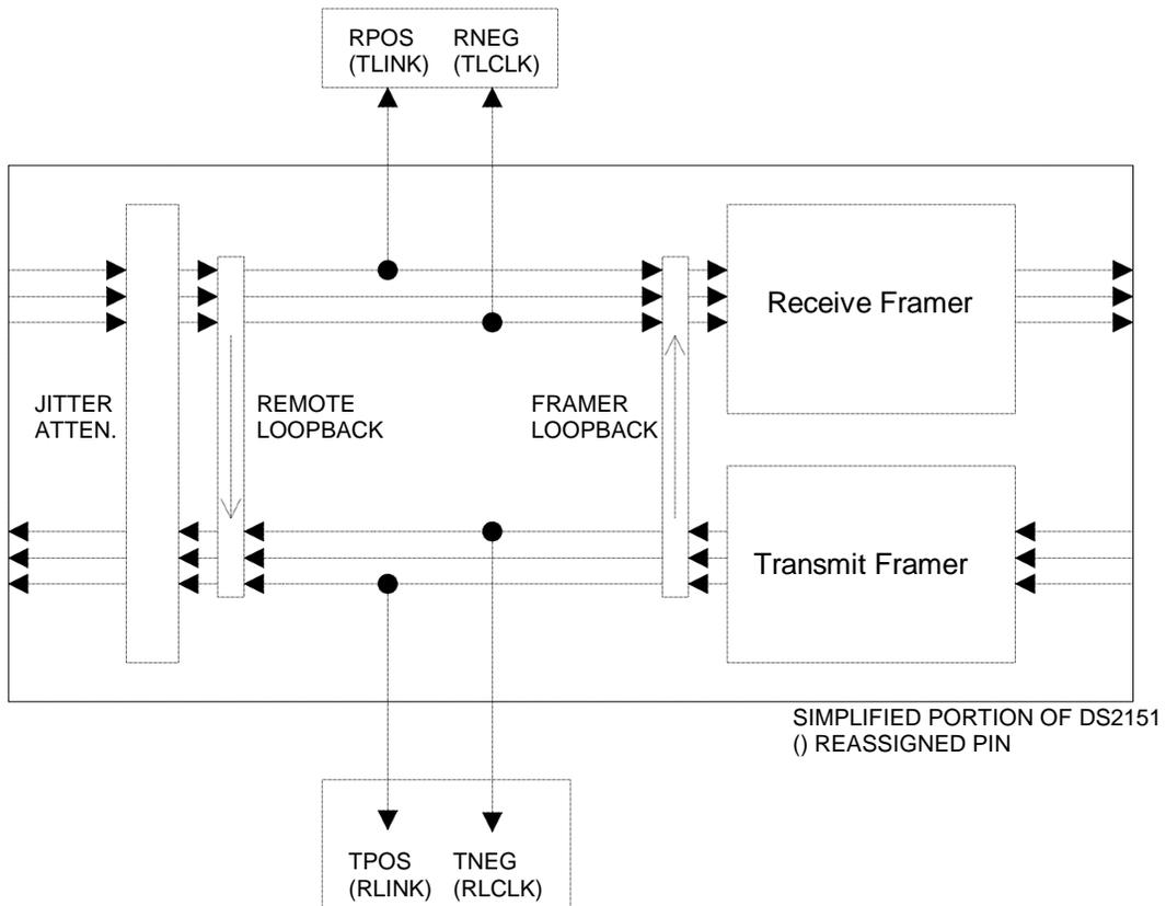
MODE 4: DS2151 Special Mode to Allow Asynchronous Backplane Clocks
