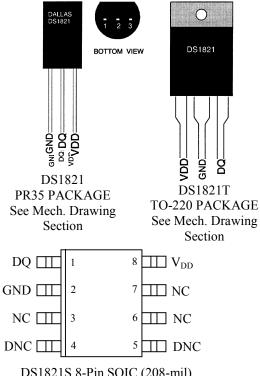
DS1821S 8-Pin SOIC (208-mil) See Mech Drawings Section
