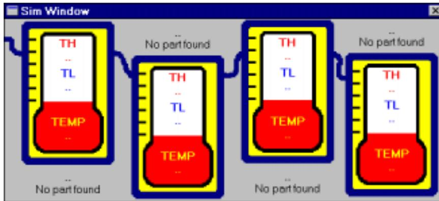
The DS1820K 1-Wire Digital Thermometer Demonstration Kit allows a potential user of the DS1820 to observe the operation of the DS1820 in an actual multipoint temperature measurement application.
