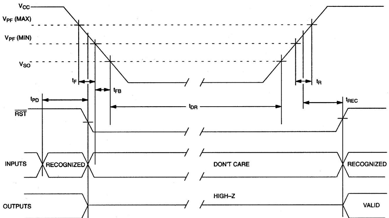
**POWER-UP/DOWN CHARACTERISTICS** (0°C to 70°C; V<sub>CC</sub> = 3.3V ±10%)
