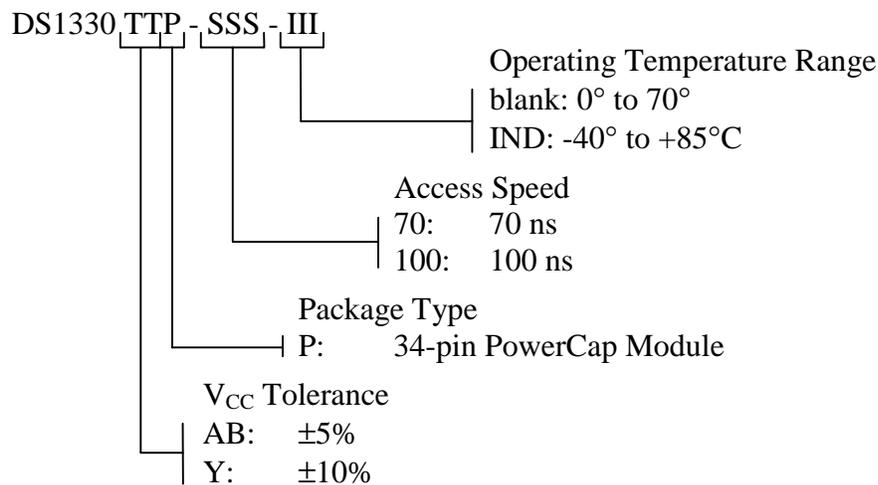
**DS1330Y/AB NONVOLATILE SRAM, 34-PIN POWERCAP MODULE**
