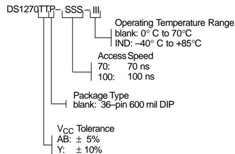
**DS1270Y/AB NONVOLATILE SRAM 36-PIN 740 MIL EXTENDED MODULE, LONG**
