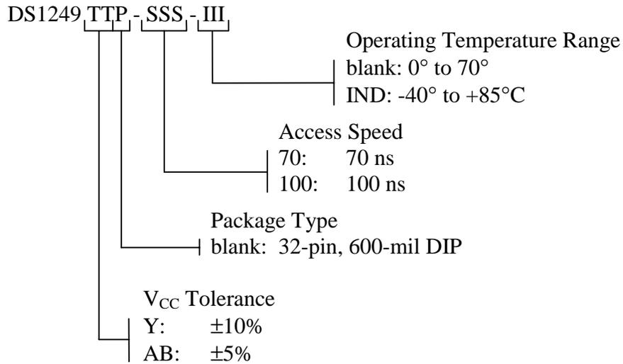
**DS1249Y/AB NONVOLATILE SRAM, 32-PIN, 740-MIL EXTENDED MODULE**
