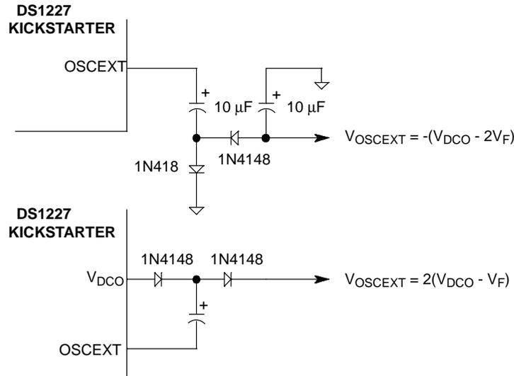
NOTE:  $V_F$  = FORWARD 1N418 DIODE VOLTAGE
