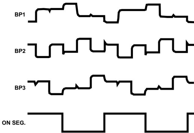
FIGURE 9. TYPICAL BACKPLANE AND ANNUNCIATOR DRIVE WAVEFORMS
