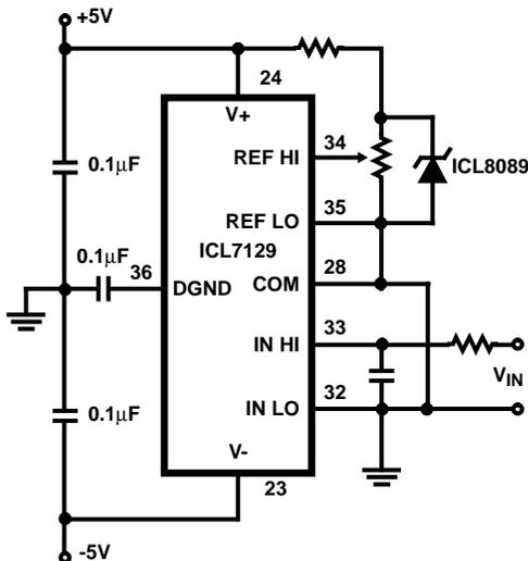
FIGURE 13. POWERING THE ICL7129 FROM +5V AND -5V
