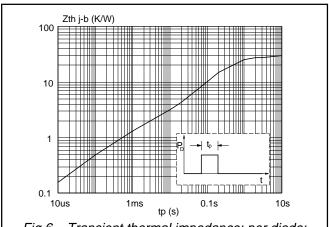
Fig.6. Transient thermal impedance; per diode;  $Z_{th j \cdot b} = f(t_p)$ .
