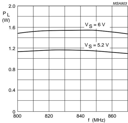
$Z_S = Z_L = 50 \Omega$ ;  $P_D = 2 \text{ mW}$ ;  $V_C = 3.5 \text{ V}$ ;  $T_{mb} = 25 \text{ }^\circ\text{C}$ .
