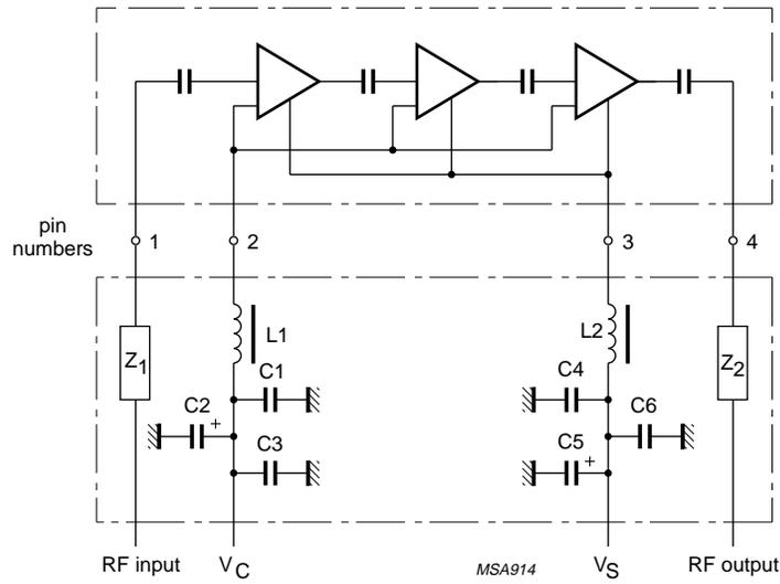
Fig.30 Test circuit.
