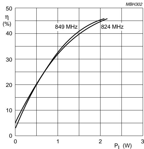
$Z_S = Z_L = 50 \Omega$ ;  $P_D = 1 \text{ mW}$ ;  $V_{S1} = V_{S2} = V_{S3} = 7.2 \text{ V}$ ;  $T_{mb} = 25^\circ\text{C}$ .
