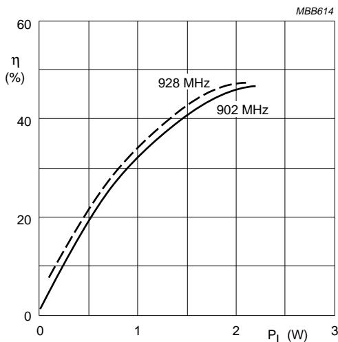
$Z_S = Z_L = 50 \Omega$ ;  $P_D = 1 \text{ mW}$ ;  $V_{S1} = V_{S2} = V_{S3} = 7.2 \text{ V}$ ;  $T_{mb} = 25^\circ\text{C}$ .
