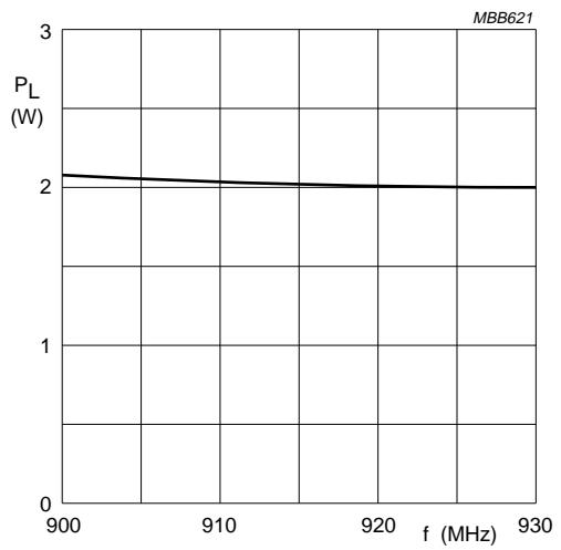
$Z_S = Z_L = 50 \Omega$ ;  $P_D = 1 \text{ mW}$ ;  $V_{S1} = V_{S2} = V_{S3} = 7.2 \text{ V}$ ;  $V_C = 4.5 \text{ V}$ ;  $T_{mb} = 25^\circ\text{C}$ .
