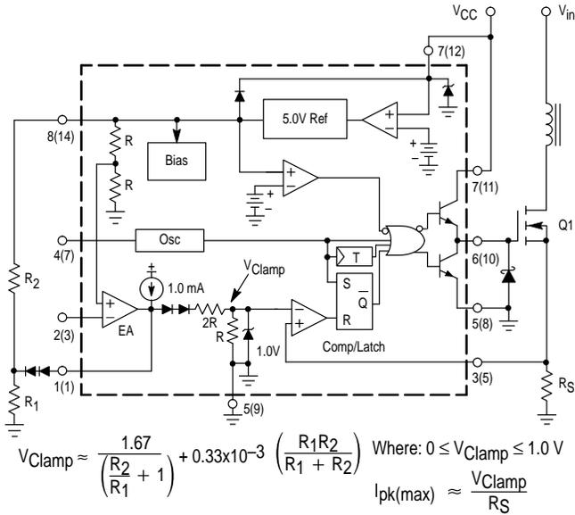
Figure 20. Soft-Start Circuit
