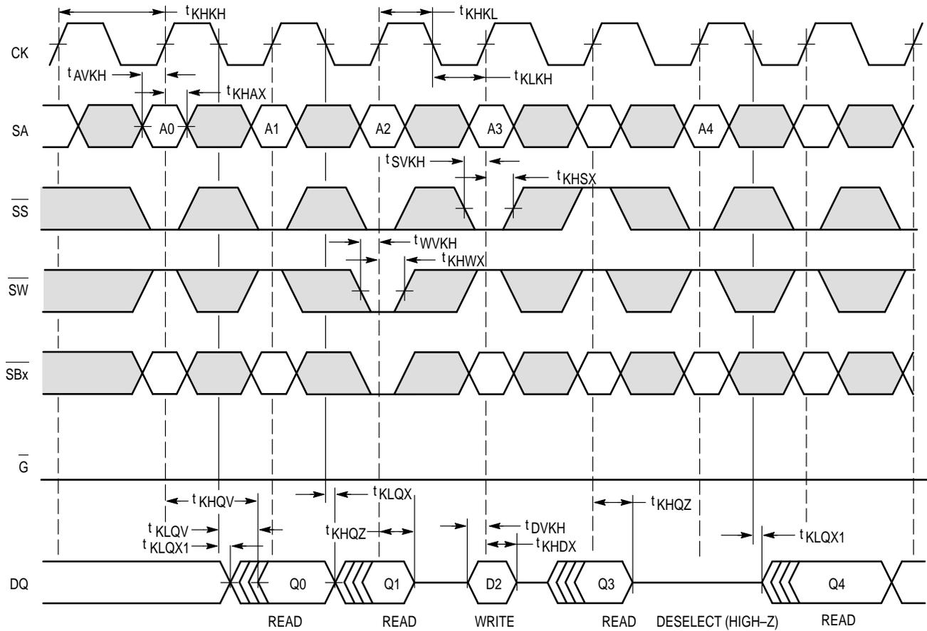
**REGISTER LATCH READ-WRITE-READ CYCLES
