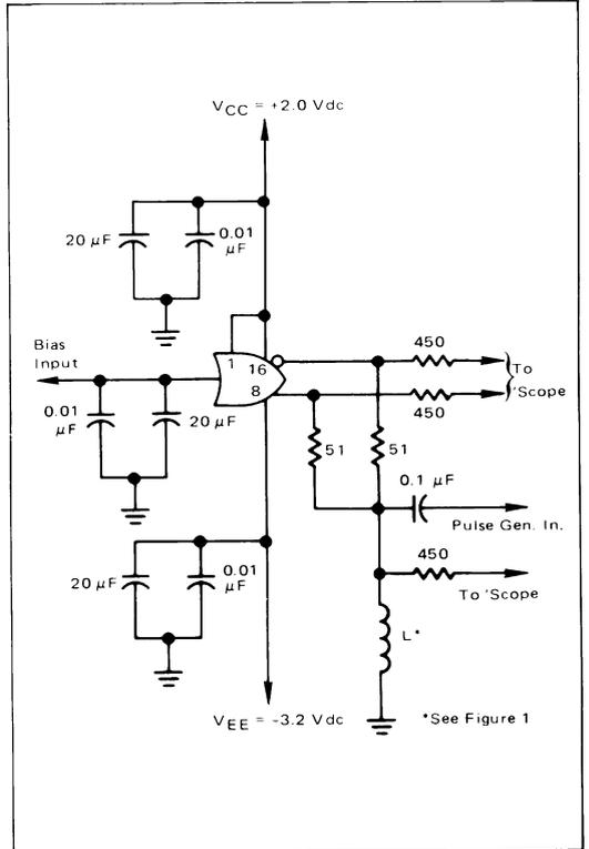
FIGURE 4 -  $V_{TT}$  NOISE TEST CIRCUIT
