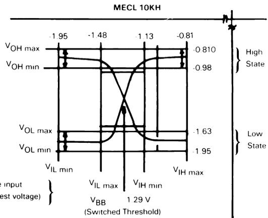
(d) MECL 10KH TRANSFER CURVES and SPECIFICATION TEST POINTS.
