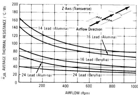
FIGURE 17B – AIRFLOW VERSUS THERMAL RESISTANCE (CERAMIC FLAT PACKAGE)
