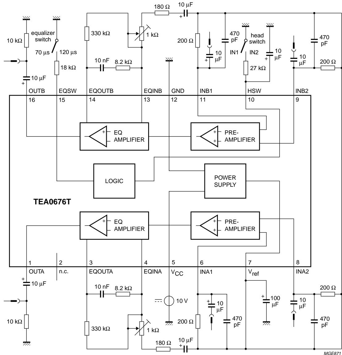
Fig.11 Test circuit.
