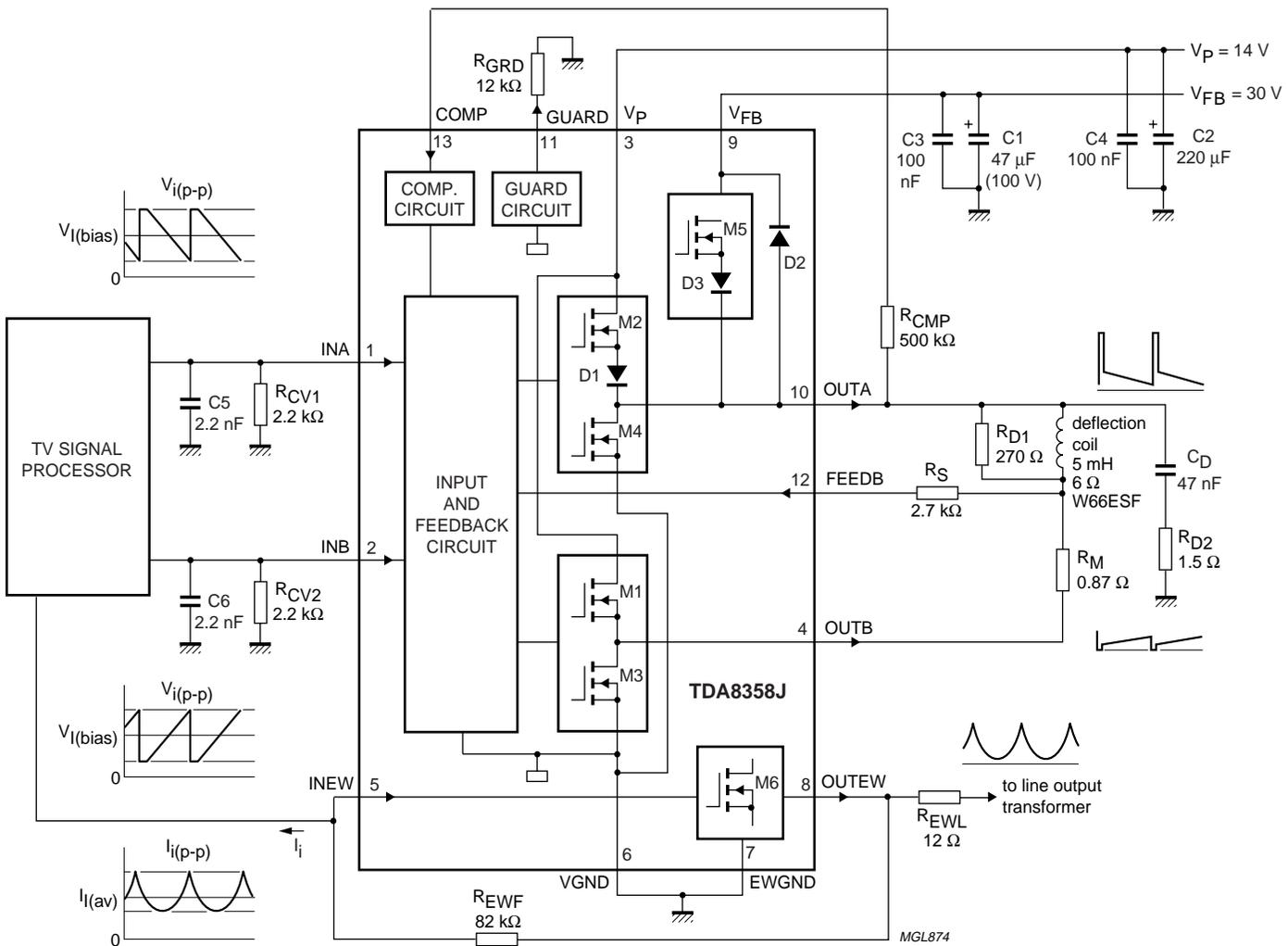
$f_{\text{vert}} = 50 \text{ Hz}$ ;  $t_{\text{FB}} = 640 \mu\text{s}$ ;  $I_{\text{I(bias)}} = 400 \mu\text{A}$ ;  $I_{\text{I(p-p)}} = 475 \mu\text{A}$ ;  $I_{\text{O(p-p)}} = 2.4 \text{ A}$ .
