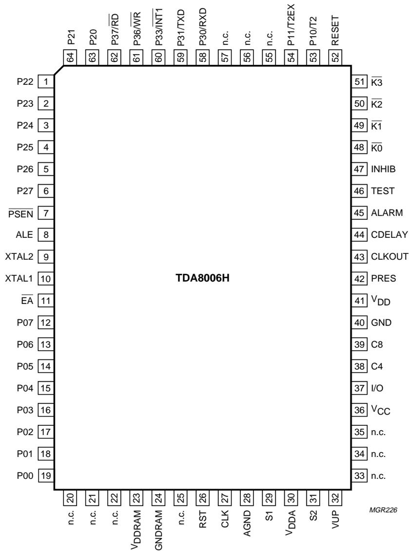
Fig.2 Pin configuration (QFP64).
