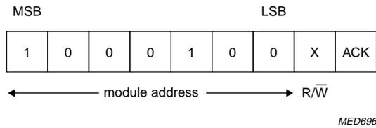
Fig.4 The module address byte.
