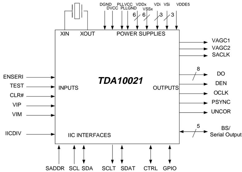
**FIGURE 3 : PIN CONFIGURATION**
