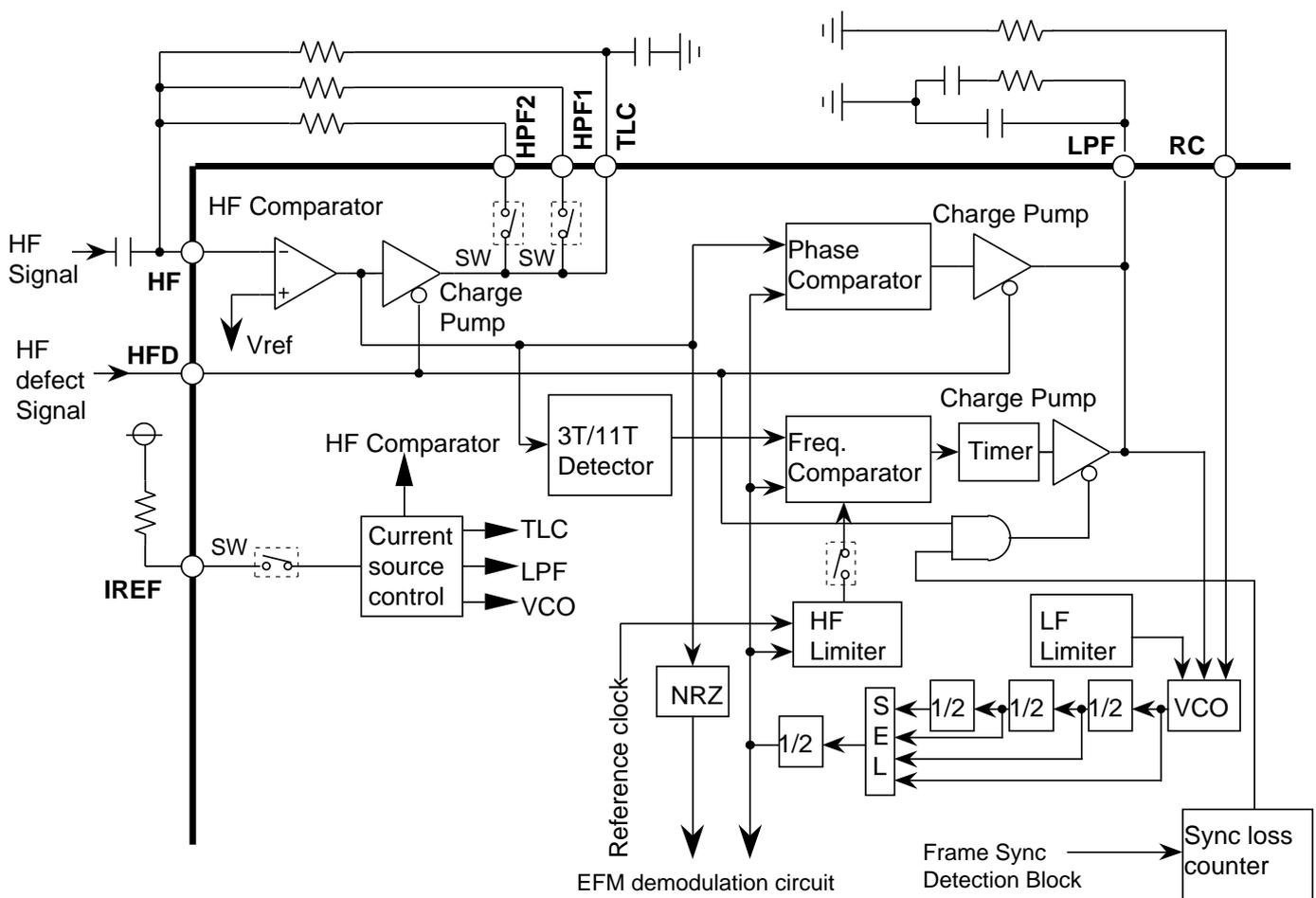
Fig. 3: EFM - PLL BLOCK DIAGRAM
