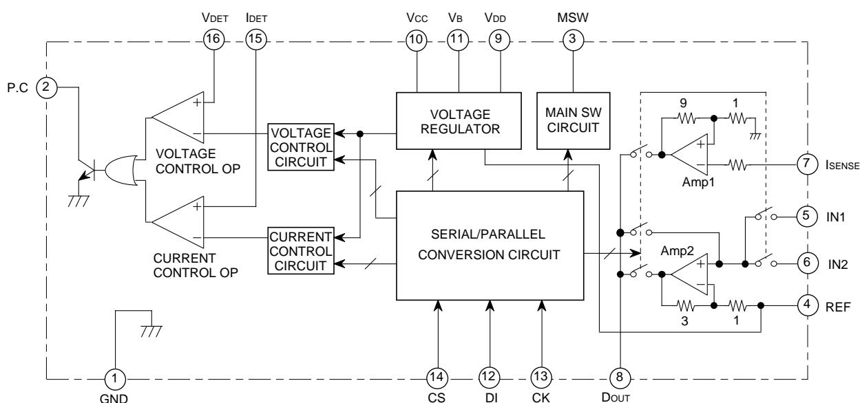
**GENERAL PURPOSE BATTERY CHARGER CONTROL IC****EXPLANATION OF TERMINALS**
