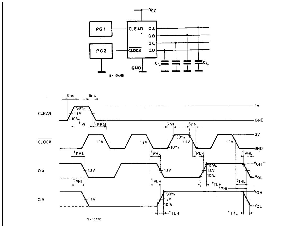
**TEST CIRCUIT I<sub>cc</sub> (Opr.)**
