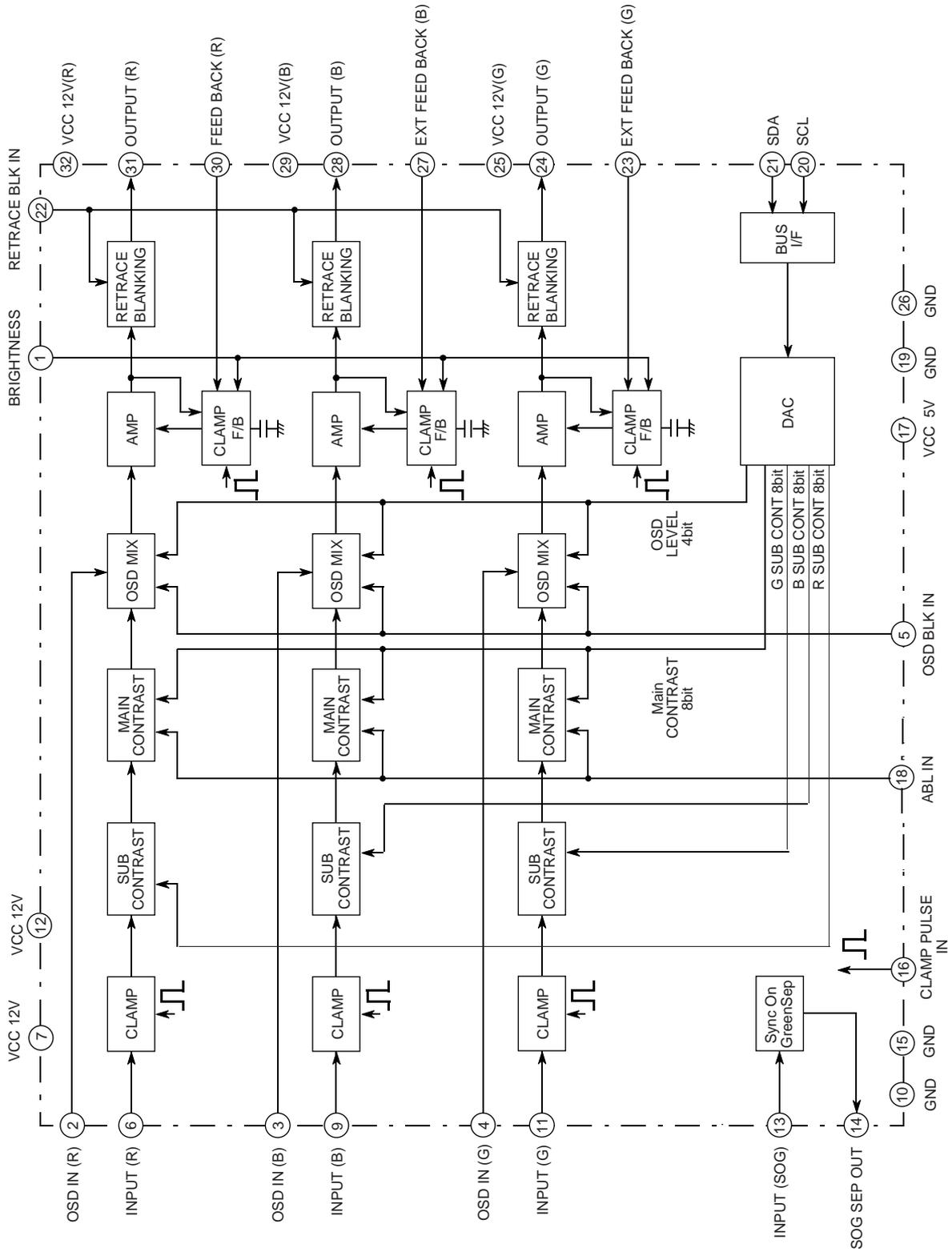
**BUS CONTROLLED 3-CHANNEL VIDEO PREAMP FOR CRT DISPLAY MONITOR**
