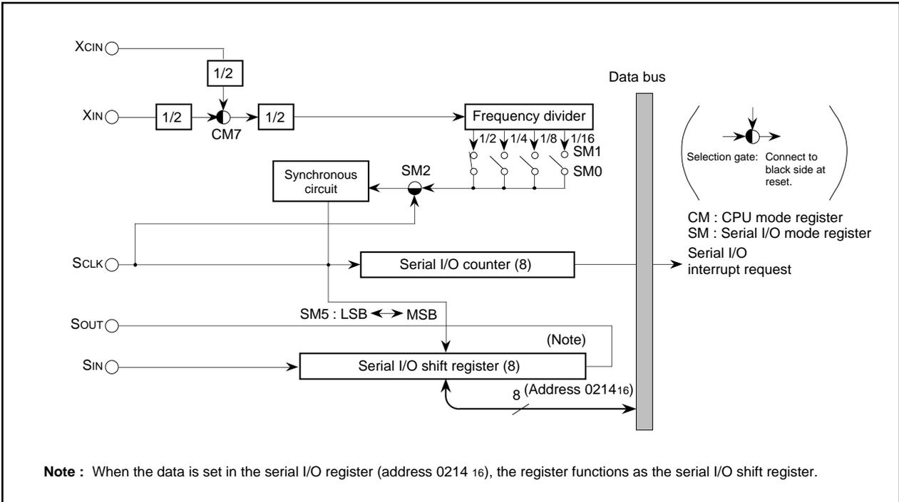
Fig. 14. Serial I/O Block Diagram
