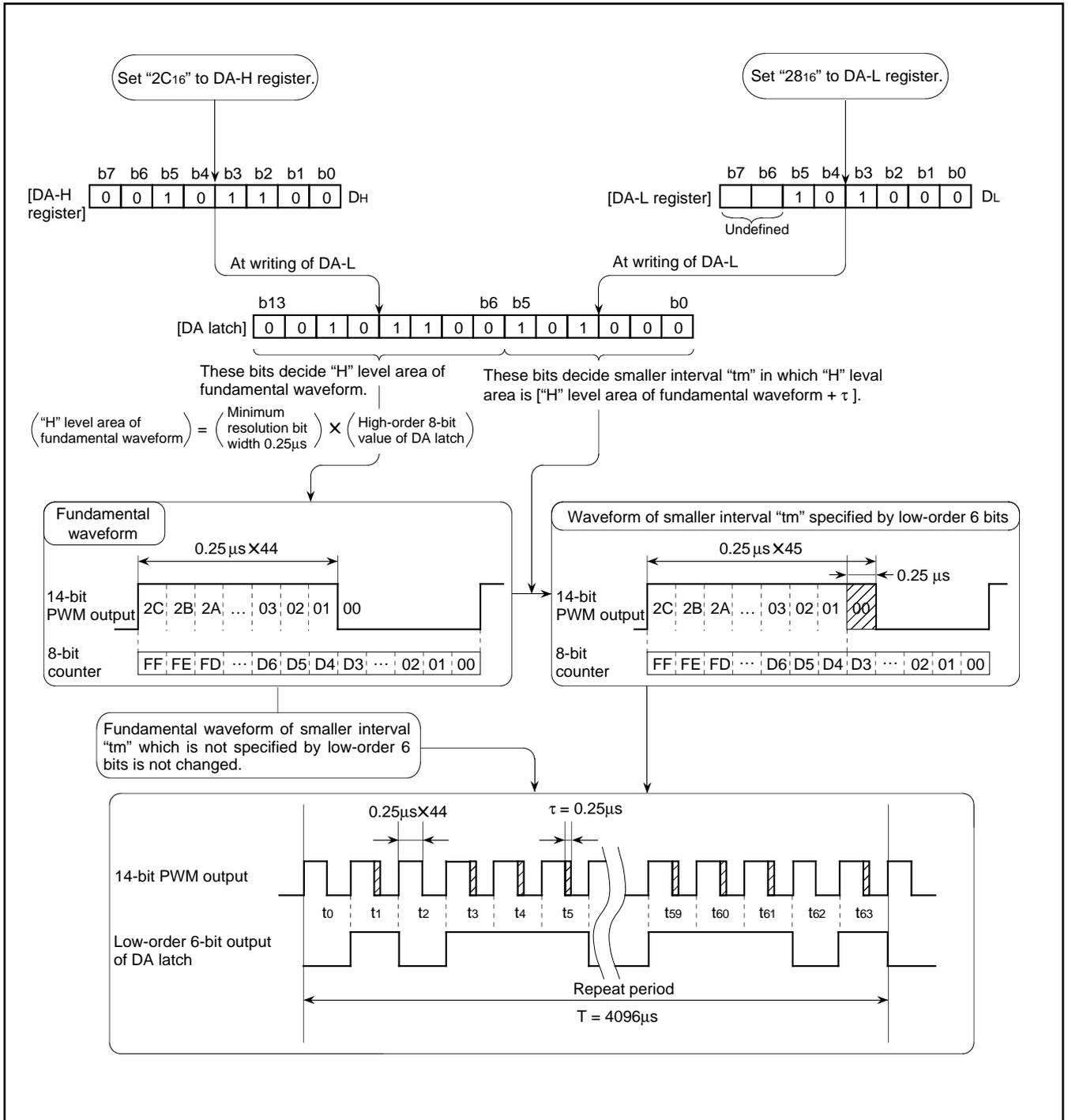
Fig. 25. 14-bit PWM output example (f(X<sub>IN</sub>) = 8 MHz)
